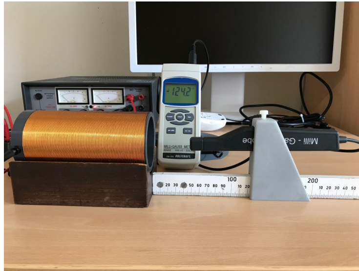
Abbildung 3: Messaufbau für die Vermessung des Spulenfelds entlang der Spulenachse.
