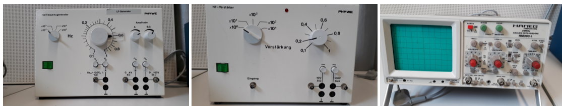
Abbildung 5: Bei der Messung verwendete elektronische Geräte: Frequenzgenerator zur Erzeugung des Stroms, Verstärker für die induzierte Spannung und Oszilloskop für die Anzeige von Strom und induzierter Spannung.
